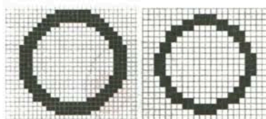
Рис. 3.1. Изображения высокого и низкого разрешения
