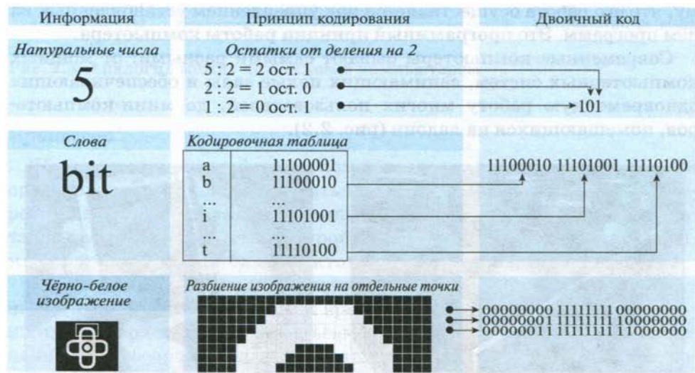
Рис. 2.1. Способы представления различных видов информации в виде двоичного кода
