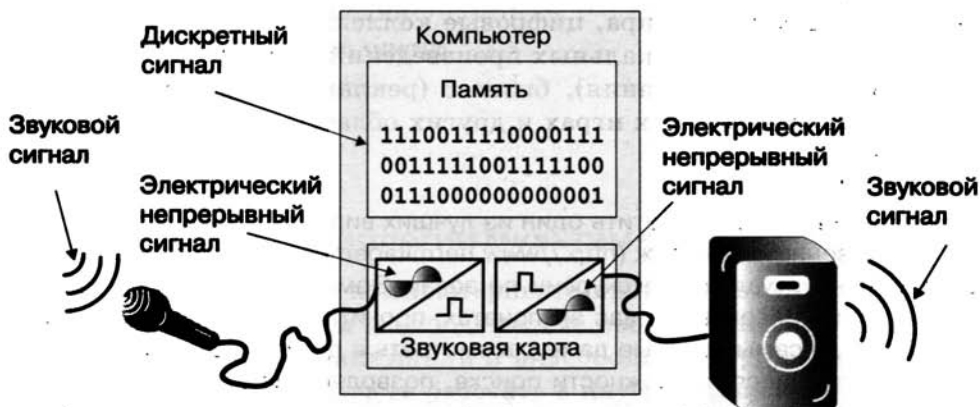
Рис. 5.1. Преобразование звука при вводе и выводе
